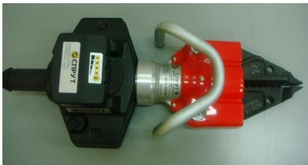
Рисунок 2 – аккумуляторное гидравлическое аварийно-спасательное оборудование
