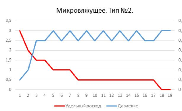
Рис. 3. Данные инъекционного нагнетания для микровязущего типа №2.
