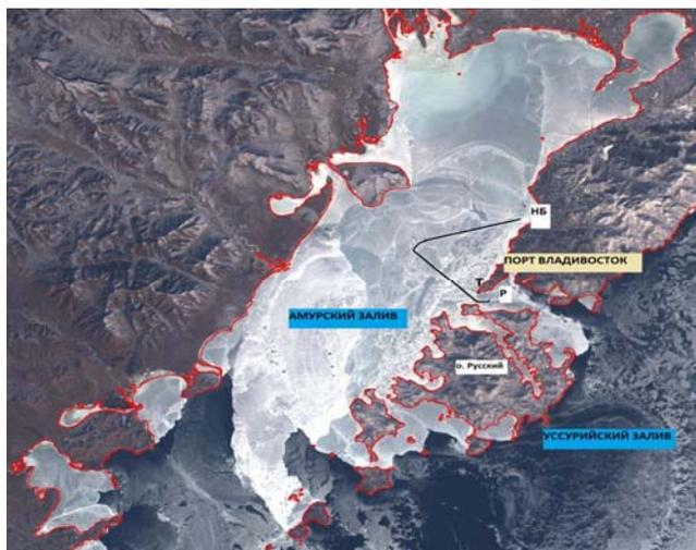
Рис. 1. Образец снимка со спутника Landsat-8 (04.02.2018) в период сложной ледовой обстановки порта Владивосток. Ледяной припай в северной части Амурского залива. НБ – нефтебаза. Дуга Р-НБ – курс ледокольной проводки судов до нефтебазы. Т – мыс Токаревский.
